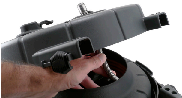
Рисунок 5 – Укладка головки камеры
