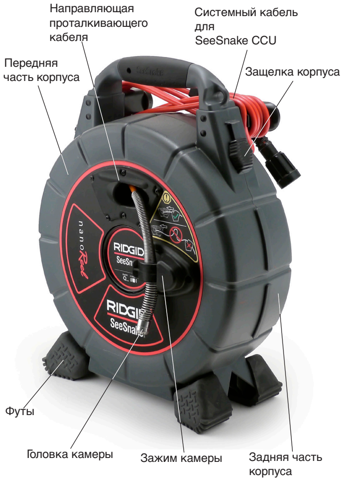
Рисунок 1 – Вид спереди (Схема SeeSnake)
