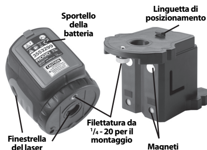
Figura 3 - Componenti della livella laser
