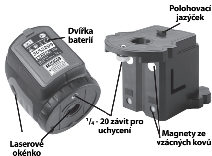
Obrázek 3 - Součásti laserové vodováhy
