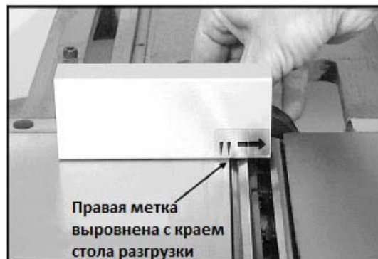
Рис. 22 (строгальный вал с прямым расположением ножей)
