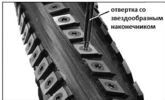
Рис. 30 (для строгального вала Helical)
