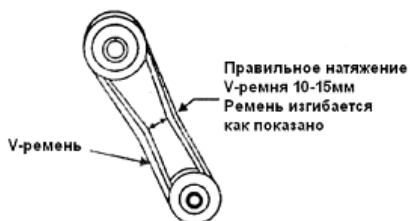
рис. 18 Натяжение V-ремня
