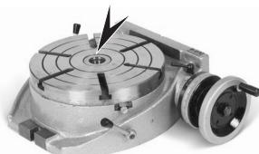
Передаточное число стола составляет 1:90. Это означает, что 90 оборотов маховика приведут к одному полному обороту стола. Один оборот маховика соответствует  $4^\circ$  поворота стола. Микро нониус разделен по  $1'$ .
