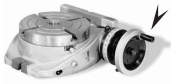
Отпустите рычаги (см. рис) вращением против часовой стрелки и поверните нониус-муфту по часовой стрелке до ее освобождения. Червячный вал при этом отсоединен от управления стола и допускает его вращение вручную. Для подсоединения червячного вала верните муфту назад и зажмите рукоятку.
