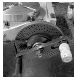
Крепление разделительной панели к столу производится после снятия маховика (см.рис.).
