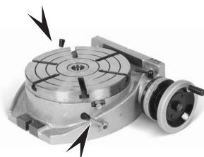
Стол оборудован шкалой, отображающей угол поворота. Индикатор предназначен для указания угла по шкале. Его можно отрегулировать после отпускания болта (см. рис.) движением в канавке. После настройки снова зажмите болт.
