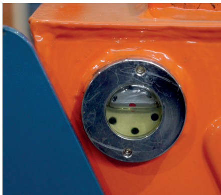
Индикатор уровня масла в гидравлической системе
