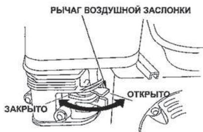
**Рычаг ВОЗДУШНОЙ ЗАСЛОНКИ** служит для открытия и закрытия воздушной заслонки в карбюраторе. В положении «ЗАКРЫТО» топливно-воздушная смесь обогащается. Это позволяет запустить «холодный» двигатель. Положение «ОТКРЫТО» используется для работы двигателя после запуска, а также для повторного запуска «горячего» двигателя.
