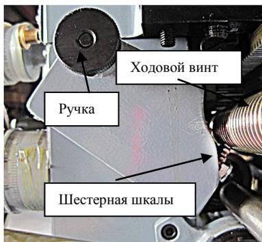
Рис. 53 . Шкала резьбы в зацеплении с ходовым винтом.
