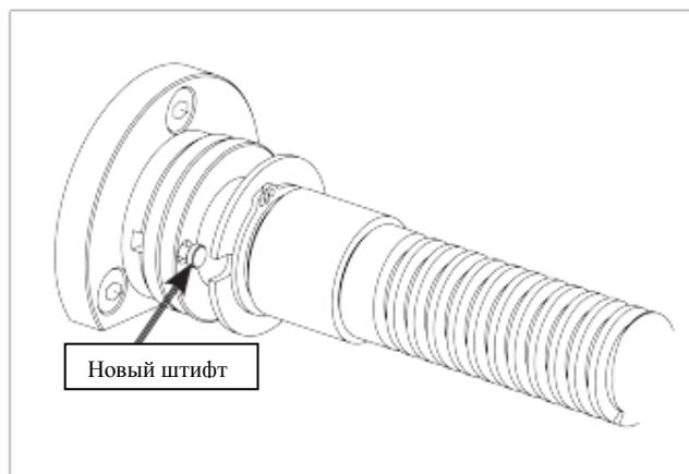
Рис. 100. Новый срезной штифт, установленный в отверстии.
