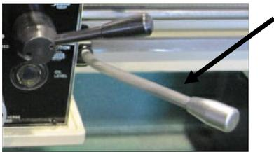
Рис. 20. Рукоятка Вкл./Выкл. шпинделя.
