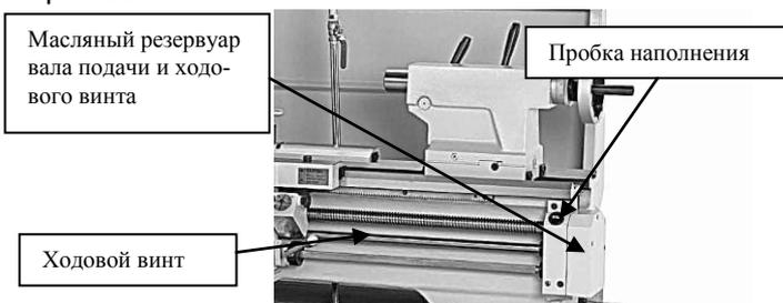
Рис. 72. Смазка ходового винта
