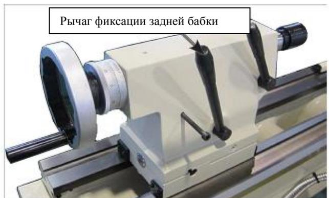
Рис. 8. Рычаг фиксации задней бабки.
