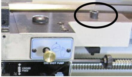
Рис. 19. Фиксатор салазок.
