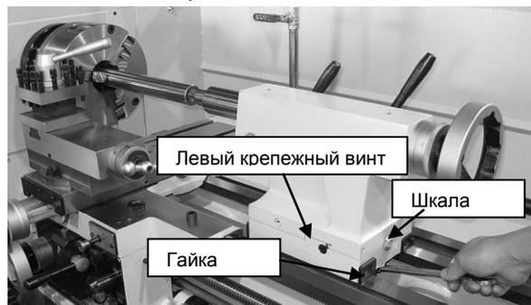
Рис. 32. Регулировка смещения задней бабки.
