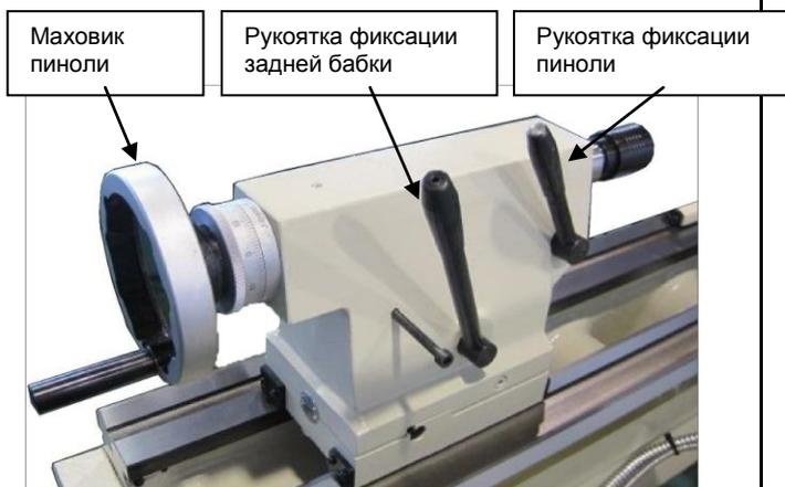
Рис. 31 Рукоятки фиксации задней бабки и пиноли в положении зажима.
