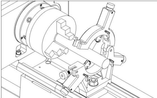
Рис. 36. Заготовка установлена в неподвижный люнет.
