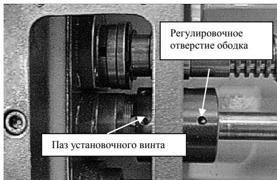
Рис. 90. Выравнивание установочного винта муфты подачи.
