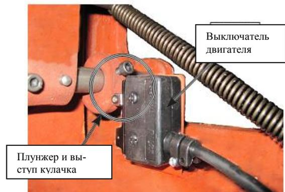
Рис. 96. Выключатель двигателя.
