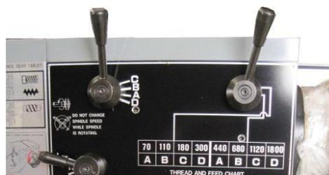
Рис. 15. Рукоятка переключения диапазонов передней бабки.
