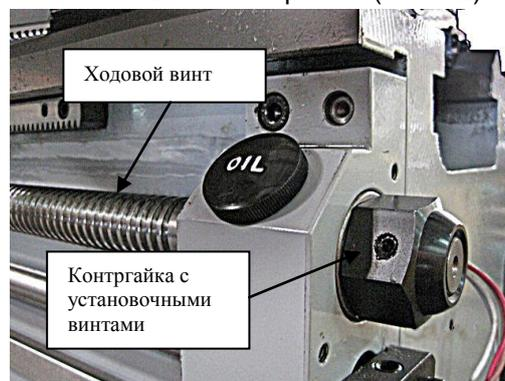
Рис. 82. Регулировка люфта ходового винта
