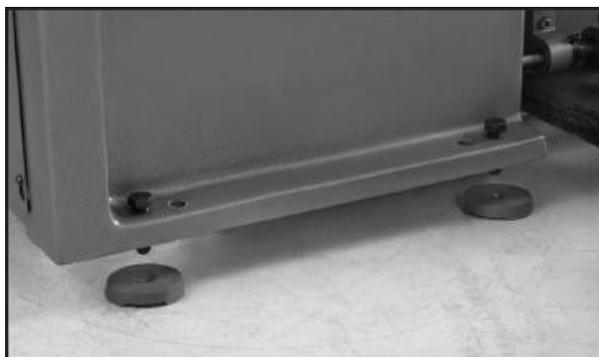
Рис.12. Выравнивание ножек и винтов
