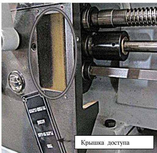
Рис. 97. Снятые крышки
