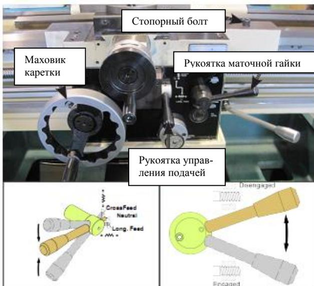
Рис.9. Механизмы управления перемещением каретки.
