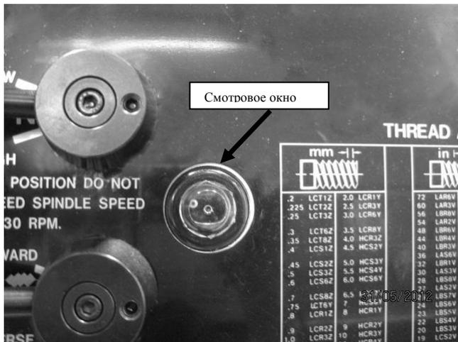
Рисунок 67. Расположение смотрового окна для масла передней бабки.
