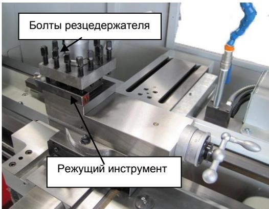
Рис. 39. 4-х позиционный резцедержатель.
