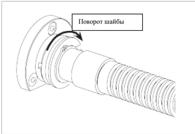
Рис. 101. Позиционирование шайбы.
