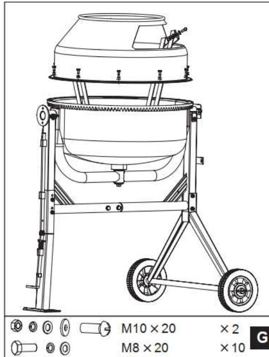
1. Расположите верхний барабан на нижнем барабане над ободом, убедившись, что монтажные отверстия совмещаются как в обоих, так и в обозначенных стрелках.
