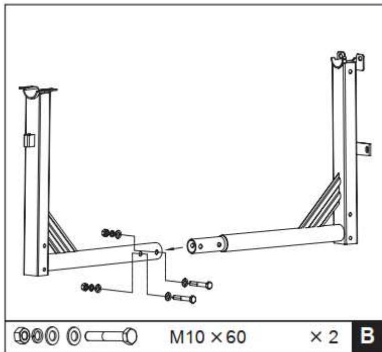
2. Вставьте две половины рамы друг в друга, как показано на рисунке. Вставьте 2 болта M10X60 с шестигранной головкой и шайбами через отверстия с одной стороны, затем плоские шайбы и контргайку, с другой стороны. Затяните.
