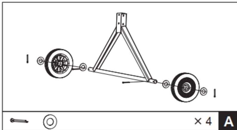
1. Вставьте шплинт в каждое ближайшее к центру отверстие в оси, наденьте на ось шайбы с обеих сторон, наденьте колеса, затем ещё шайбу с каждой стороны и ещё по шплинту с каждой наружной стороны. Отогните концы шплинтов.
