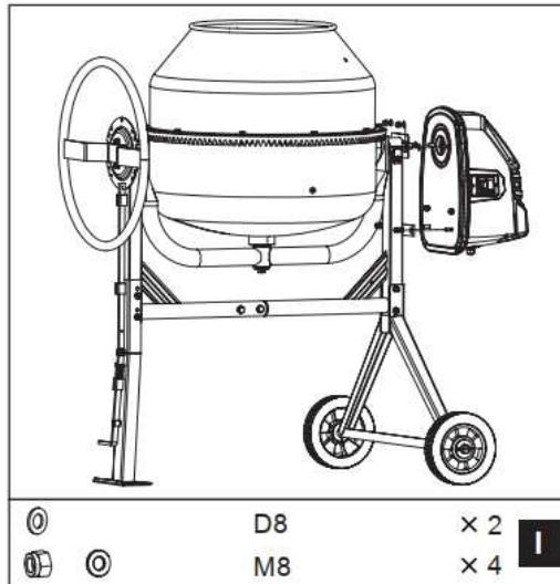
Аккуратно установите блок двигателя на вал бетоносмесителя. Убедитесь в том, что крепежные болты, находящиеся на блоке двигателя, вошли в крепежные отверстия. Накрутите гайки M8 на болты, предварительно установив плоские шайбы и стопорные шайбы. Убедитесь в том, что все гайки плотно затянуты.
