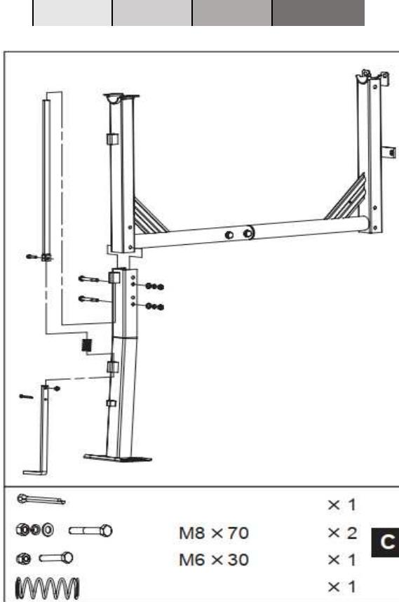
3. К раме, лежащей на боку, прикрепите опорную ногу, как показано на рисунке. Вставьте 2 шестигранных болта M8x70 в отверстия с одной стороны, затем поставьте плоские шайбы, стопорные шайбы и гайки. Наденьте пружину на стержень нижнего плунжера. Скрепите стержни плунжеров, шестигранным болтом M6x30 и гайкой. Для удержания пружины на месте вставьте разжимной шплинт и разогните его концы. Затяните
