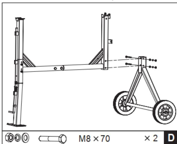
Поверните раму и прикрепите кронштейн с осью и колесами таким же способом.
