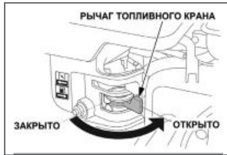
Рис. 16 Рычаг топливного крана Т-60, Т-80, Т-90, Т-100
