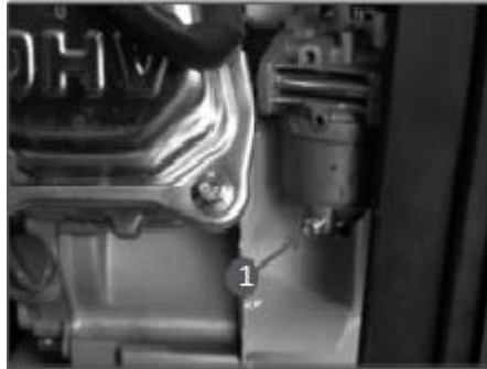
Рис. 24 Обслуживание фильтра отстойника Т-50 1. Винт
