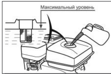
Рис. 13 Максимальный уровень топлива в топливном баке
