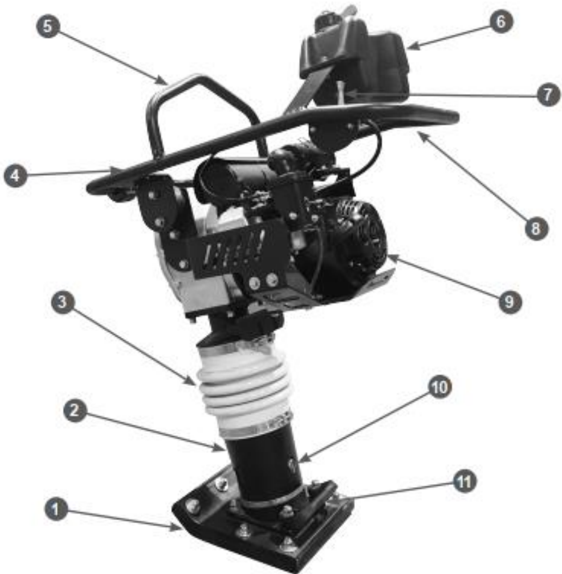
Рис.1 - Основные узлы и органы управления (вид спереди)
