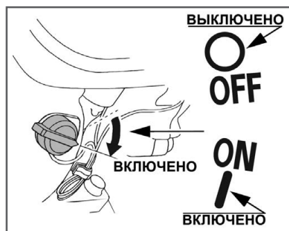
Рис. 12 - Выключатель зажигания в положении «Включено»
