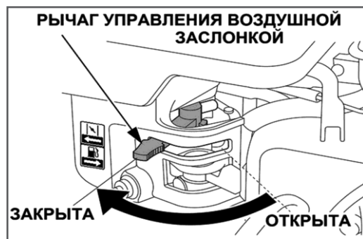
Рис.10 - Воздушная заслонка закрыта
