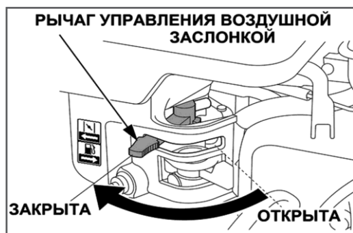
Рис.10 Воздушная заслонка закрыта
