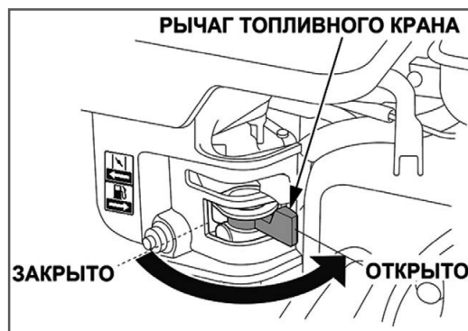
Рис.9 Топливный кран карбюратора
