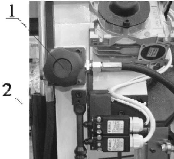
Гидравлический механизм вертикального перемещения плеча состоит из гидроцилиндра 2 (см. рис.6), вентиля регулирующего скорость перемещения 1 и емкости под масло с электронасосом (находятся внутри подставки).
