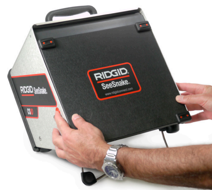
Рисунок 7 – Открытие передней крышки
