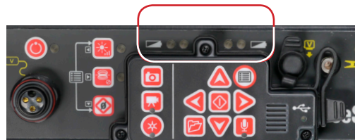
Рисунок 10 – Светодиодные индикаторы состояния батареи
