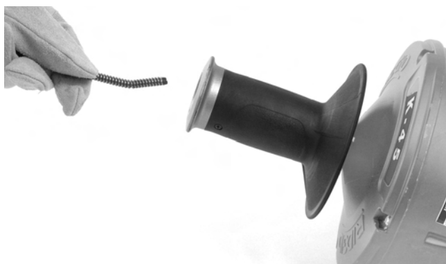
Slika 17 – Uvlačenje sajle bez zamjene unutarnjeg bubnja
