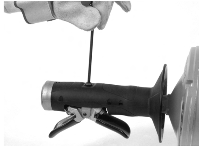
12A ábra – Az AUTOFEED csavar eltávolítása
