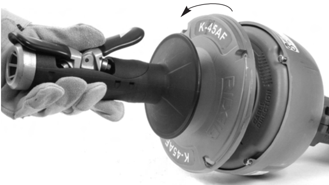
14. ábra – A dob szétcsavarása
