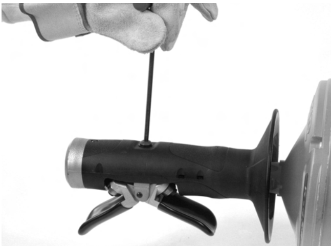
Obrázok č. 12A – Demontáž skrutky mechanizmu AUTOFEED
