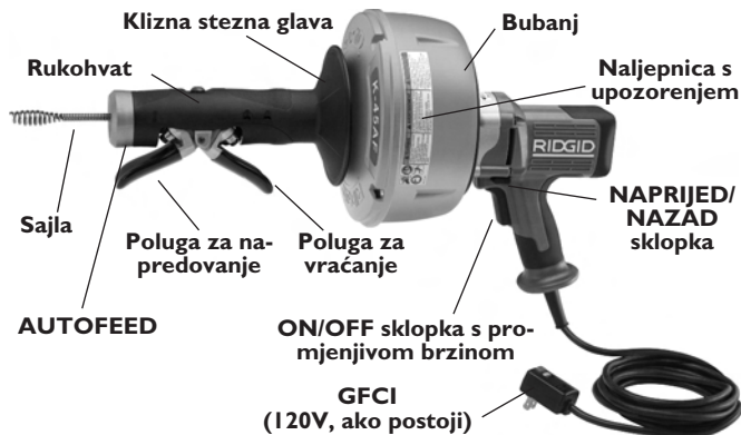
Slika 2 – K-45 stroj za čišćenje odvoda s AUTOFEED-om
