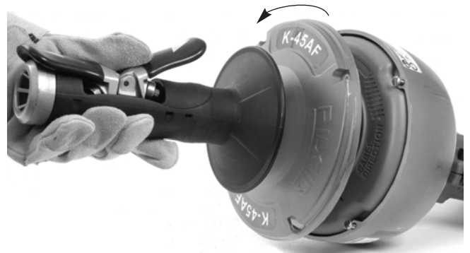
Slika 14 – Zakretanje odvojenog bubnja
