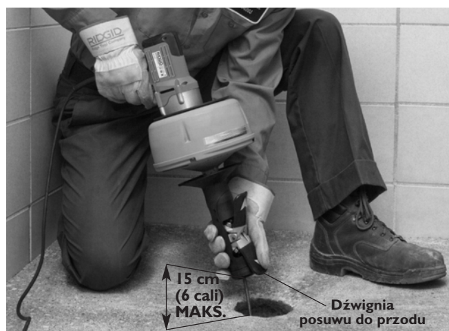
Rysunek 10 – Wprowadzanie sprężyny za pomocą funkcji autoposuwu AUTOFEED
