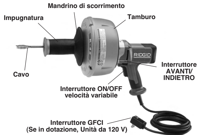
Figura 1 – Macchina stasatrice K-45 con mandrino di scorrimento
