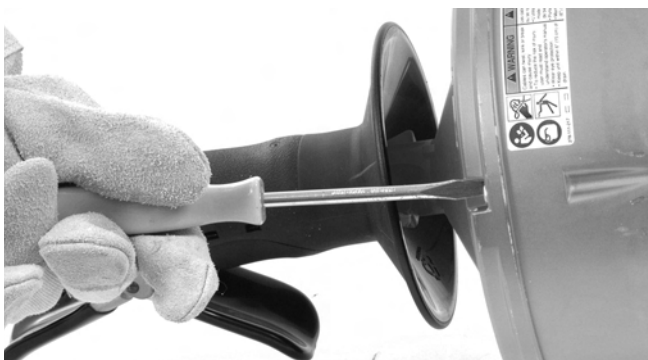
Figur 13 – Løsn de 4 tromleskruer ca. 3 hele omdrejninger, men fjern dem ikke
