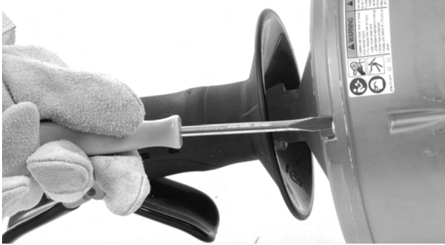
Kuva 13 – Löysää kelan neljää ruuvia noin kolmella kierroksella, mutta älä irrota ruuveja
