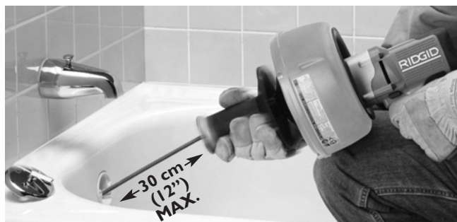
Obrázek 8 – Pro uchopení kabelu upínacím pouzdem posuňte rukojeť k bubnu
