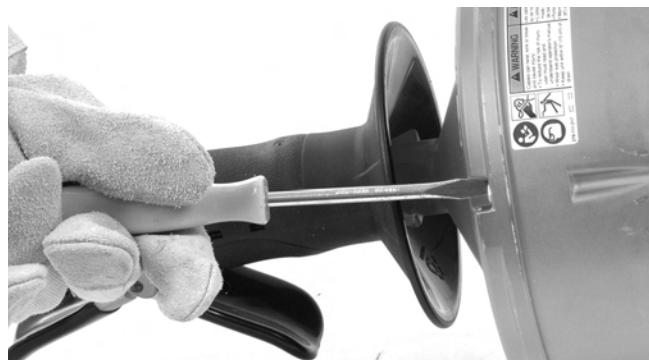
Abbildung 13 – 4 Trommelschrauben etwa 3 Umdrehungen lösen, aber nicht entfernen
