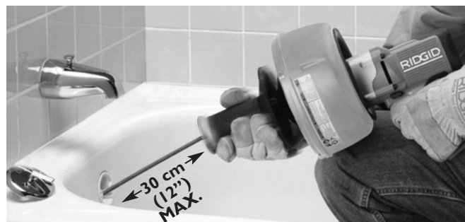
8. ábra – A fogantyút a dob felé mozdítva fogja meg a tokmánnyal a kábelt
