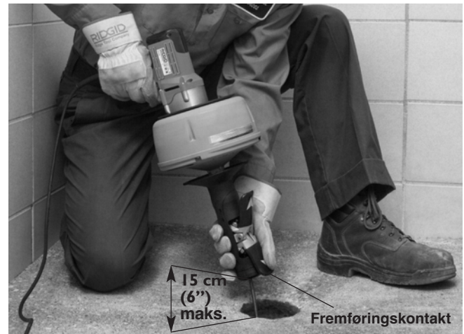
Figur 10 – Fremføring af spiralen med AUTOFEED
