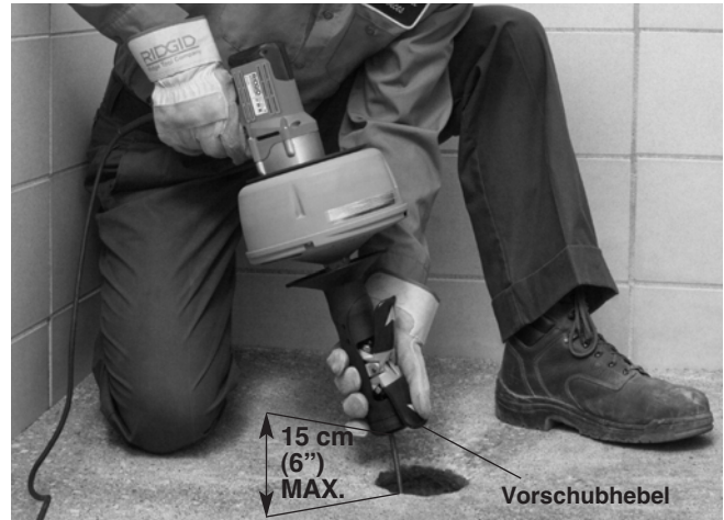
Abbildung 10 – Vorwärtsschieben der Spirale mit AUTO-FEED
