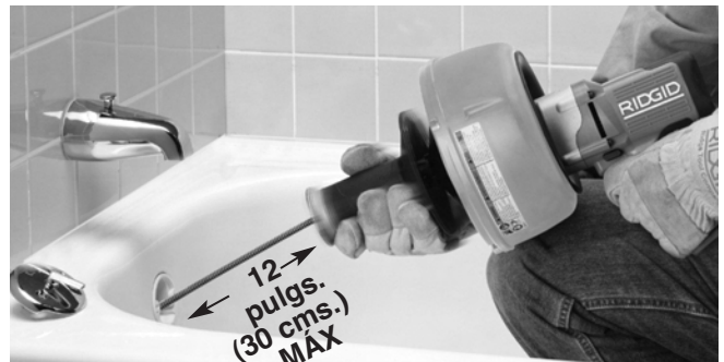
Figura 8 – Mueva la empuñadura hacia atrás para enganchar el cable con el portabrocas
