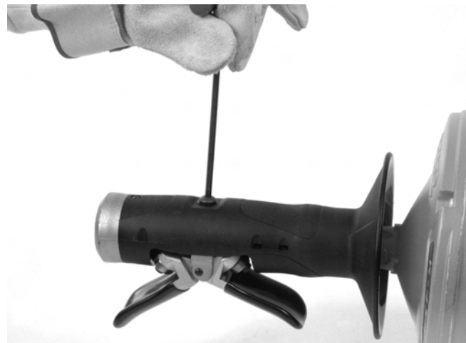
Kuva 12A – AUTOFEED-ruuvin irrottaminen
