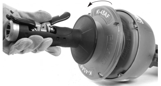
Slika 14 – Boben odprite z vrtenjem
