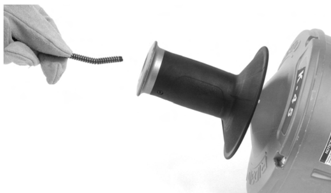
Figuur 17 – Veer laden zonder binnenhaspel te vervangen
