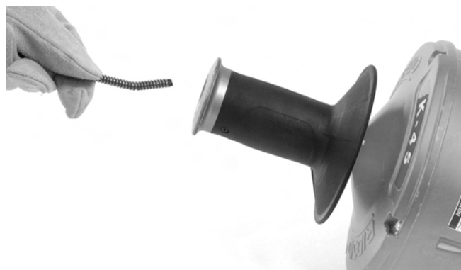
Rysunek 17 – Ładowanie sprężyny bez wymiany wewnętrznego bębna
