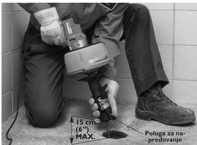
Slika 10 – Uvlačenje sajle s AUTOFEED-om
