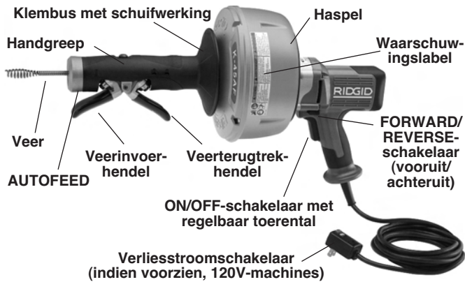
Figuur 2 – K-45 AF Afvoerontstoppingsmachine met AUTOFEED
