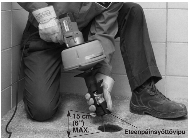
Kuva 10 – Jousen syöttäminen AUTOFEED-toiminnolla
