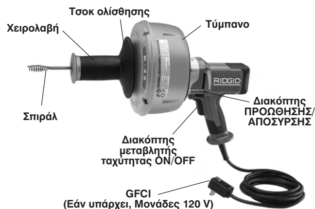
Εικόνα 1 - Μηχάνημα απόφραξης αποχετεύσεων με τσοκ ολίσθησης K-45
