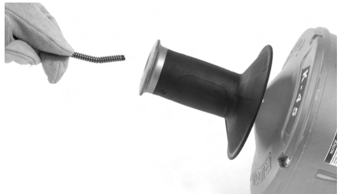
Kuva 17 – Jousen lataaminen vaihtamatta sisäkela
