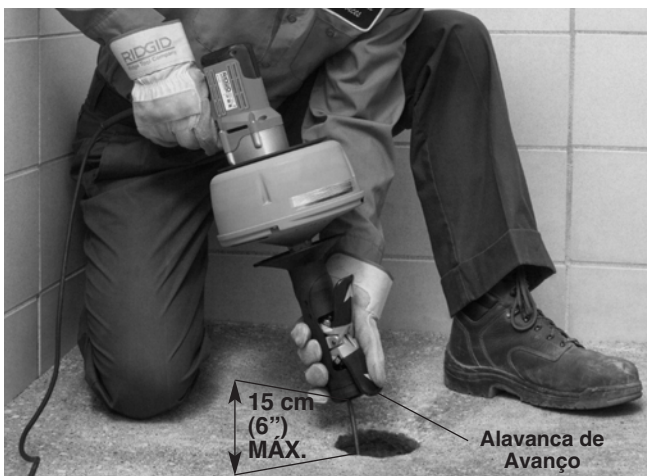
Figura 10 – Avançar o cabo com AUTOFEED
