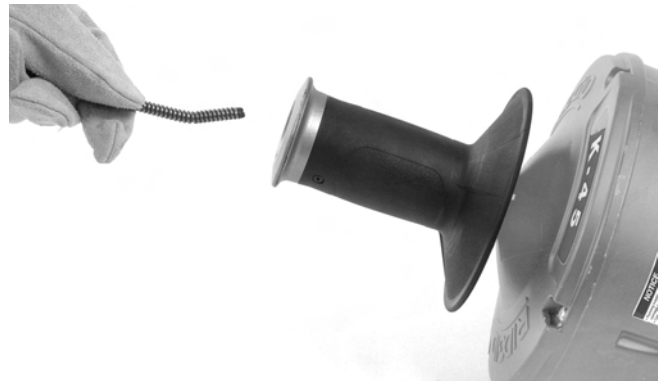
Şekil 17 - İç Makarayı Değiştirmeden Spiralin Yüklenmesi
