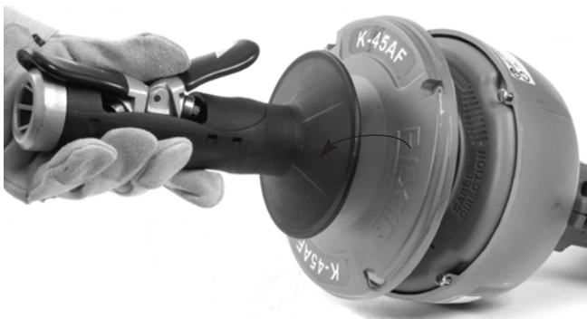
Obrázok č. 14 – Demontáž bubna
