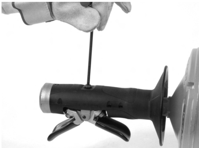
Slika 12B – Odstranjevanje mehanizma AUTOFEED iz ohišja
