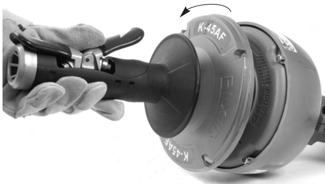
Рис. 14 – Проверните и отделите крышки барабана
