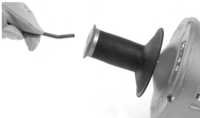
Figura 17 – Caricamento del cavo senza rimuovere il tamburo interno
