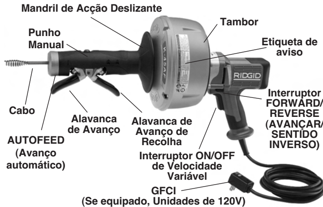
Figura 2 – Máquina de Limpeza de Tubagens K-45 AF com AUTOFEED
