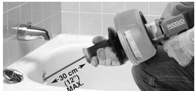
Figuur 8 – Beweeg handgreep naar haspel om veer met klembus te omklemmen
