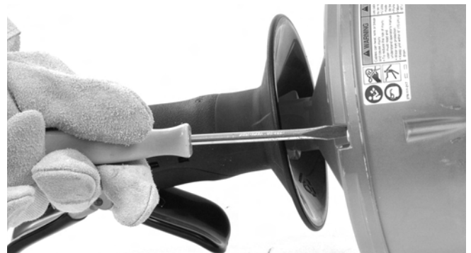
Slika 13 – Olabavite 4 vijka bubnja za oko 3 puna obrtaja, ali ih nemojte skidati
