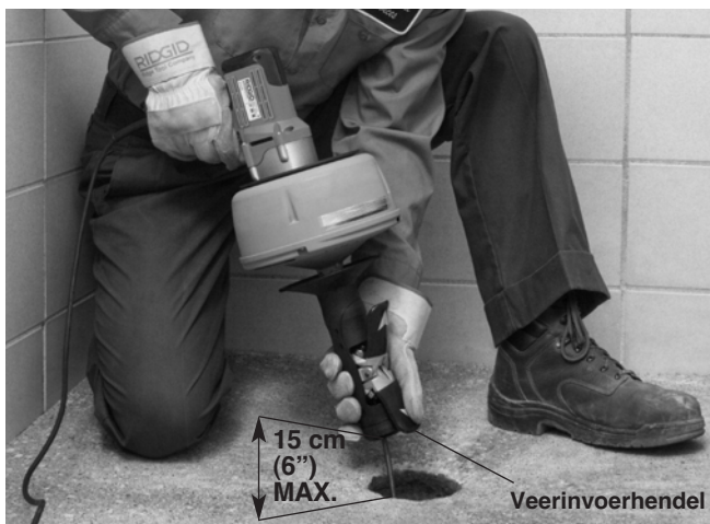
Figuur 10 – Veer invoeren met AUTOFEED
