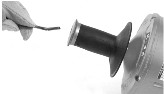
Abbildung 17 – Einlegen der Spirale ohne Wechsel der Innentrommel
