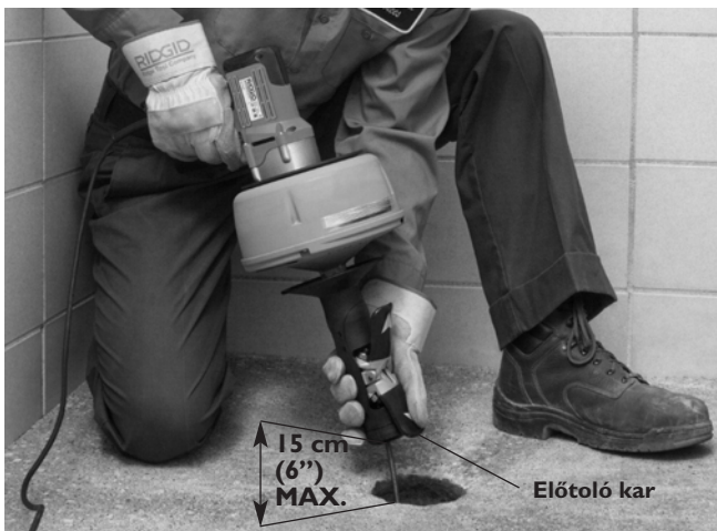
10. ábra – A kábel előtolása az AUTOFEED funkcióval
