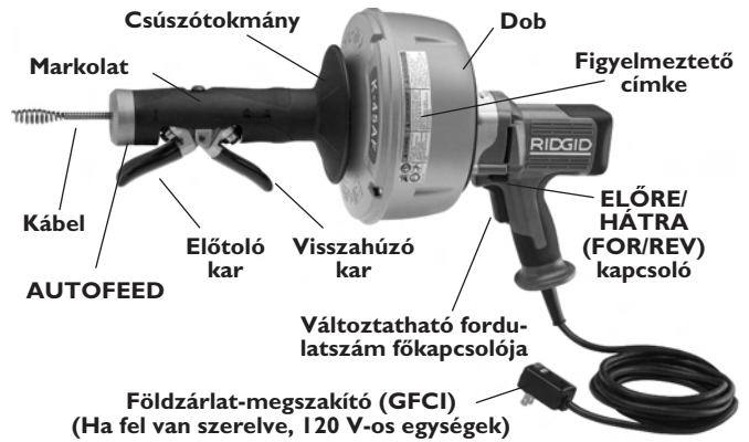
2. ábra – K-45 AF lefolyótisztító gép AUTOFEED előtöl- lással
