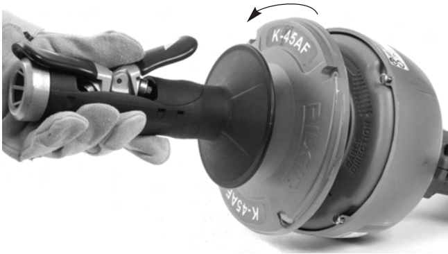
Abbildung 14 – Auseinanderdrehen der Trommel
