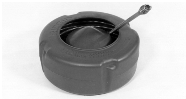
Slika 16 – Ko vstavljate kabel v notranji boben, navijte kabel v DESNO
