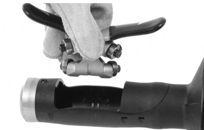
Rysunek 12B - Wymywanie mechanizmu AUTOFEED z obudowy
