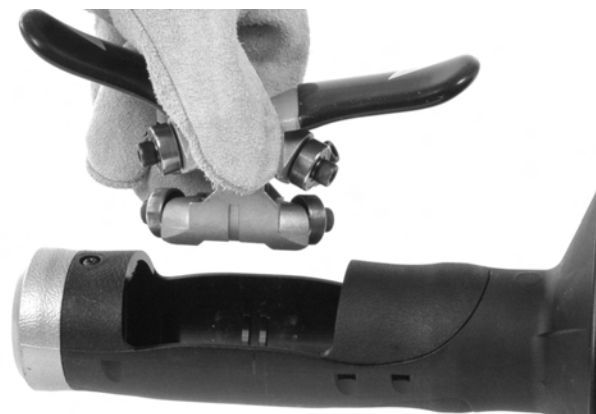
Slika 12B – Skidanje AUTOFEED mehanizama s kućišta
