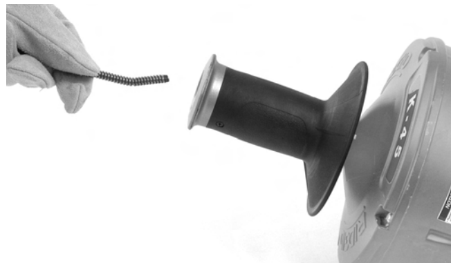
Рис. 17 – Загрузка троса без замены внутреннего барабана
