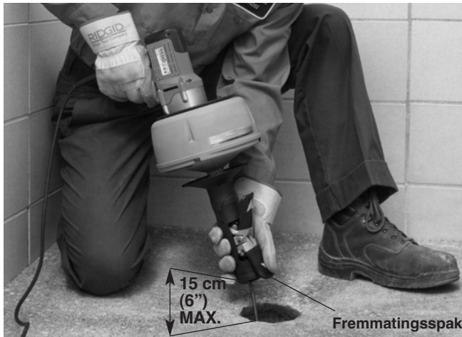
Figur 10 – Mating av kabel med AUTOFEED
