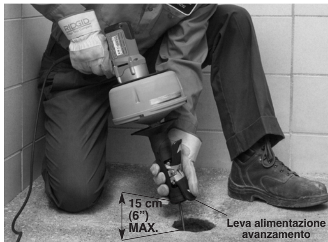
Figura 10 – Alimentazione del cavo in modalità AUTO-FEED
