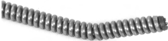
Figura 15 – Curva na extremidade do cabo
