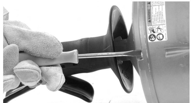
Slika 13 – 4 vijake bobna popustite za približno 3 obrate, vendar jih ne odstranite
