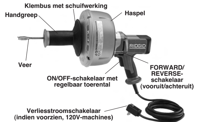
Figuur 1 – K-45 Afvoerontstoppingsmachine met klembus met schuifwerking
