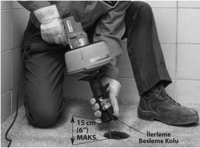
Şekil 10 – AUTOFEED ile Kablonun Beslenmesi
