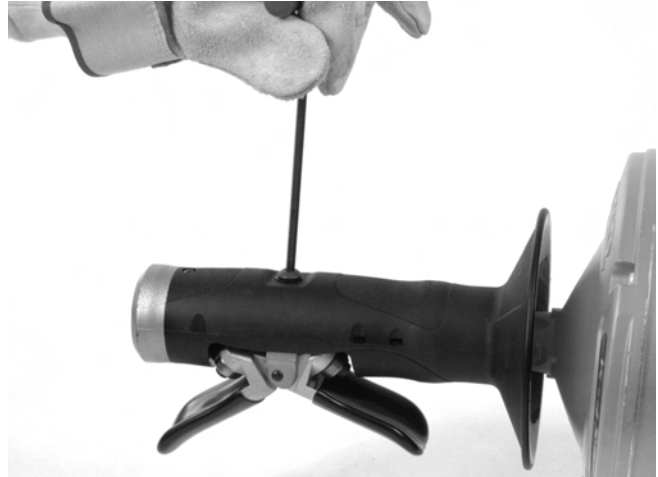
Εικόνα 12A - Αφαίρεση βίδας μηχανισμού AUTOFEED
