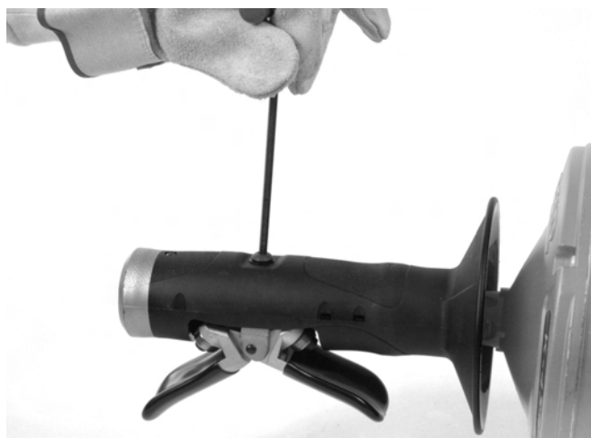
Figura 12A – Retirar o Parafuso AUTOFEED
