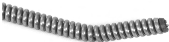
Figura 15 – Piega all'estremità del cavo
