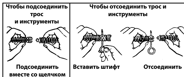
Рис. 1: Соединение и разъединение тросов и инструментов
