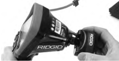
Рис. 18 – Вилка разъема видеокамеры подключена
