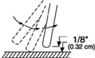
Рисунок 7. Зажигание дуги
