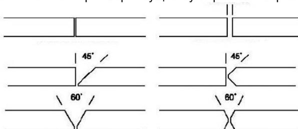
**Рисунок 3. Стыковые соединения**
