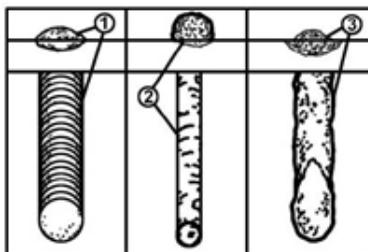
**Рисунок 5. Виды сварочного шва**
