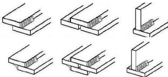
**Рисунок 4. Угловые соединения**
