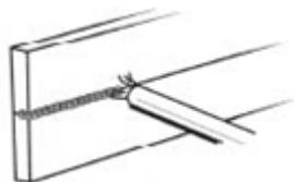
Рисунок 12. Горизонтальное положение при сварке
