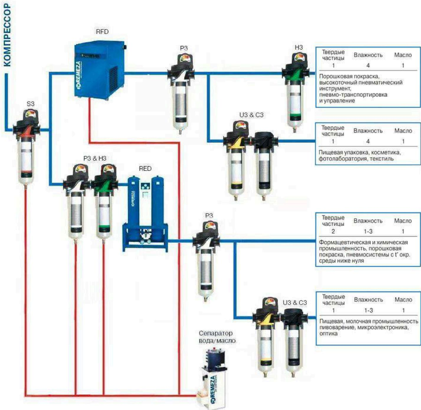
Рис. 5 Схема комплектной компрессорной станции
