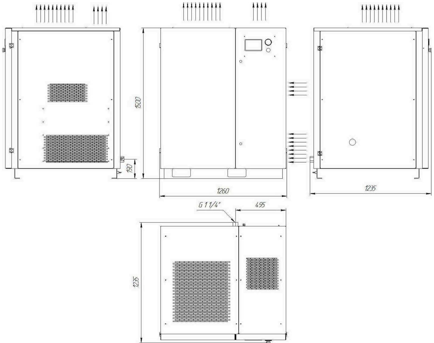
Рис.9 Присоединительные и установочные размеры компрессорной установки
